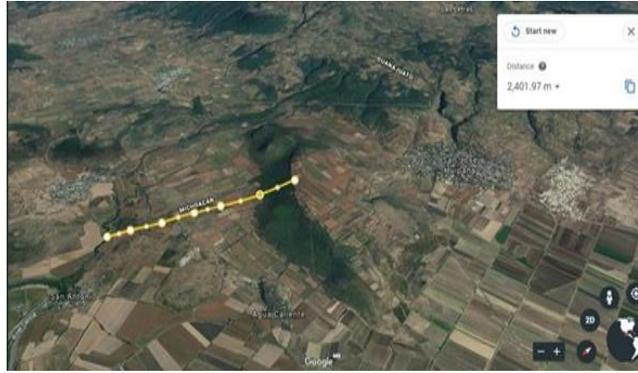
**Imagen 32.** Tubería de San José Huipana. Desnivel de 140 metros desde la salida hasta la descarga. Longitud de  $\approx$  2500 metros
